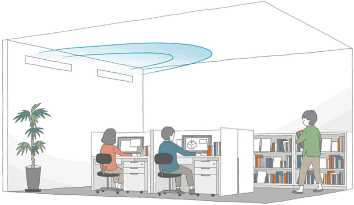
図3 高い天井高、優れた換気性能、省エネを実現する変風量コアンダ空調システム
