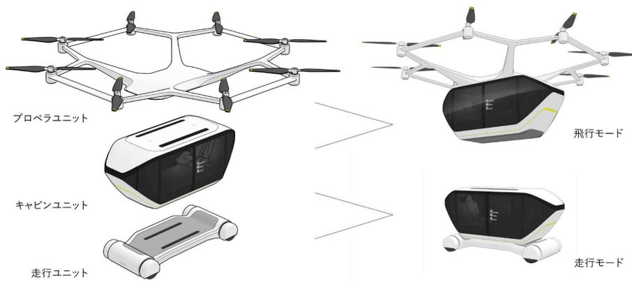
モジュラー型モビリティ・システムとして、プロペラ、キャビン、走行の3つのユニットを組み合わせ、空と地上を移動します。
